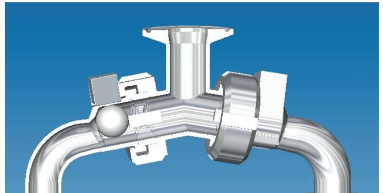
Weiche Umlenkungen ohne rotierende Teile und Wellenabdichtungen im Produktraum führen zusammen mit der prinzipbedingten schonenden Verdrängungsförderung zu einer besonderen Eignung für die vorgesehenen Einsatzfälle.
