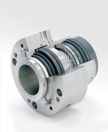
Diese Doppel-Gleitringdichtung, eine vormontierte betriebsbereite Cartridge-Einheit verfügt über „High-Tech“ Konstruktionsmerkmale wie: stationäre Bauart (innen und außen), Doppel-Druckentlastung (API Plan 52 oder 53), Verwendung ausschließlich massiver, selbstjustierend gelagerter Gleit- und Gegenringe, gelenkte Zirkulationsführung, integrierte Umwälzeinrichtung sowie die erforderlichen API-Merkmale.
