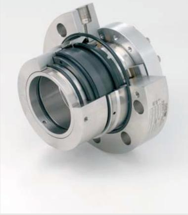
Dieser Gleitringdichtungs-Typ ist speziell für Anwendungen mit hohen Drücken bis zu 130 bar an der Gleitringdichtung und gleichzeitig hohen Drehzahlen (höchste pv-Faktoren) ausgelegt. Zusätzlich ist er extrem resistent gegen verschmutzte und feststoffbeladene Medien, wie z.B. Rohöl mit 30 %-igem Wachsanteil. Hauptsächlich Einsatz in Pipeline-Pumpen.
