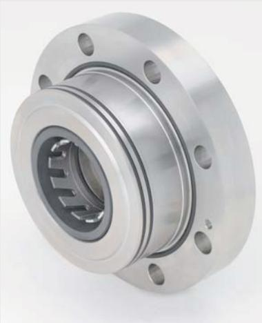
Diese „heavy duty“ Doppel-Gleitringdichtungen sind speziell konzipiert für Anwendungen in Wasserinjektions-Pumpen (WIP). Sie sind ausgelegt für Höchstbeanspruchungen bei Druck, Geschwindigkeit und Medienbeschaffenheit (Sand-Wasser-Rohölgemisch). Ein typisches Beispiel für den WIP-Einsatz sind Pumpendrucke bis 300 bar und Drehzahlen von 6000 min<sup>-1</sup> bei einem Sperrdruck von 90 bar.
